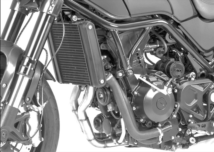
Das Sturzpad wird an der vorderen Verbindung von Motor und Rahmen montiert. Die originale Mutter SW14 ist zu verwenden.
