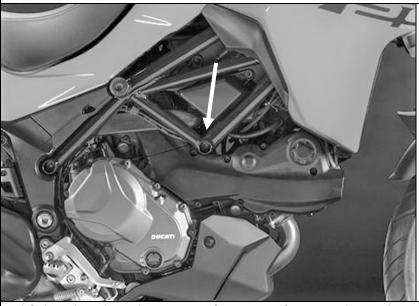
Das Sturzpad wird an der vorderen Verbindung von Motor und Rahmen montiert.
