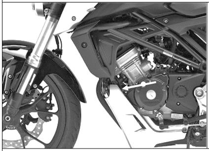
Das Sturzpad wird an der vorderen Verbindung von Motor und Rahmen montiert. Die Verkleidung ist entsprechend zu lösen.
