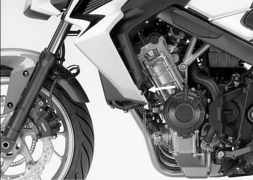
Das Sturzpad wird an der vorderen Verbindung von Motor und Rahmen montiert. Evtl. ist die Seitenverkleidung etwas zu lösen.
