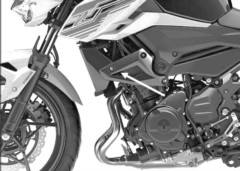
Das Sturzpad wird an der vorderen Verbindung von Motor und Rahmen montiert. Die Rahmenverkleidung muss für die Montage gelöst werden. Die Distanzbuchse vom Halter bitte zwischen Profilblech und Rahmen positionieren. Die Hupe um 180 Grad nach hinten versetzen (auf ausreichend Freiraum achten, evt. Anschlusspins leicht biegen!)
