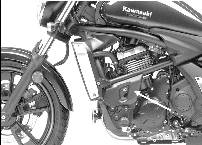
Das Sturzpad wird an der vorderen Verbindung von Motor und Rahmen montiert. Die originale Abdeckblende ist samt Gummimuffen zu lösen. Die Gummimuffen bitte an der Grundplatte (Löcher mit Senkung) anbringen. Die Schraube M5x25 mit der Distanzbuchse 14x5x12,5 sowie die Schraube M6x16 zur Befestigung der Blende verwenden.
