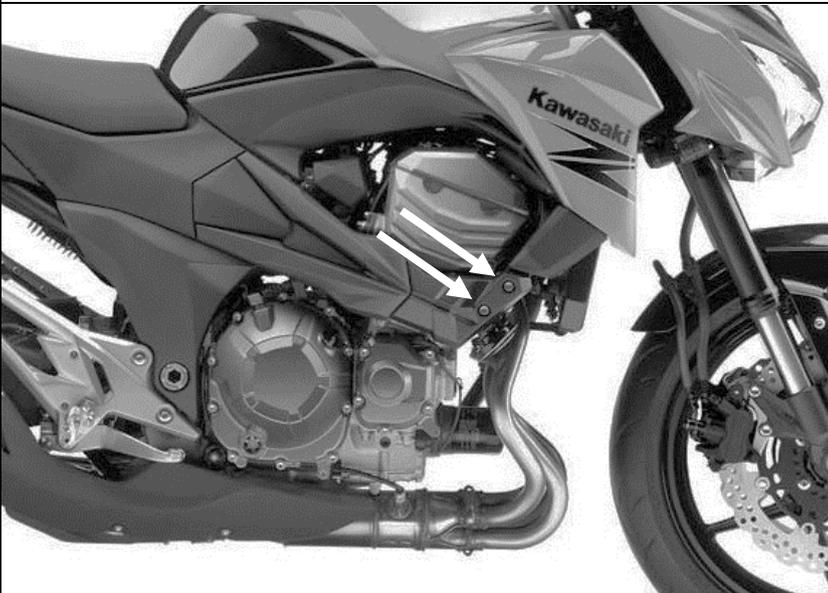
Das Sturzpad wird an der vorderen Rahmenverschraubung montiert.
