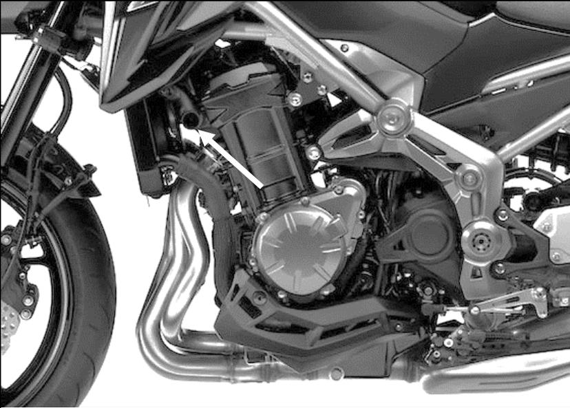
Das Sturzpad wird an der vorderen Verbindung von Motor und Rahmen montiert.
