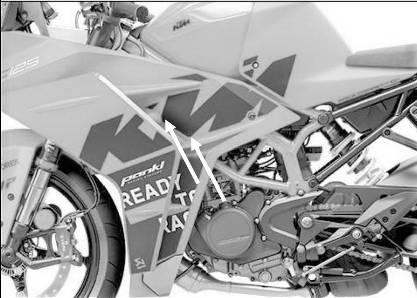
Die Seitenverkleidung ist zu lösen und der innere Verkleidungszapfen zu entfernen. Die Grundplatte ist an den seitlichen Schrauben (Motorträger) zu befestigen.
