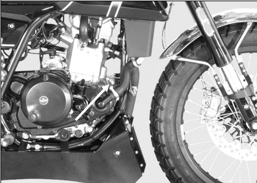
Das Sturzpad wird an der vorderen Verbindung von Motor und Rahmen montiert. Die Schraubverbindung (M10x120mm) bitte mit 48 Nm festziehen.
