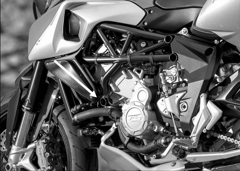
Das Sturzpad wird an der vorderen Verbindung von Motor und Rahmen montiert. Die M10er Stoppmuttern der Gewindestange sind mit 45 Nm festzuziehen.
