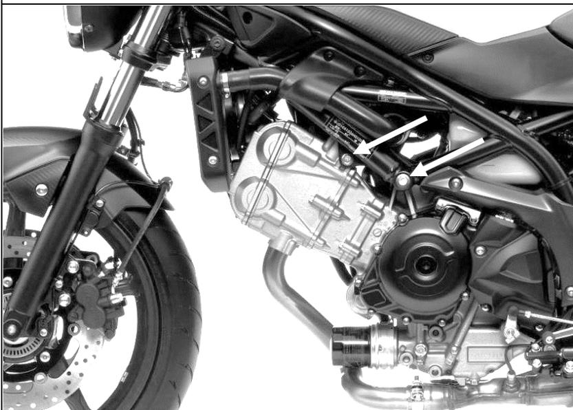
Das Sturzpad wird an der hinteren Verbindung von Motor und Rahmen montiert. Bei der Gladius muss die Seitenverkleidung über dem Anschraubpunkt etwas ausgeschnitten werden.
