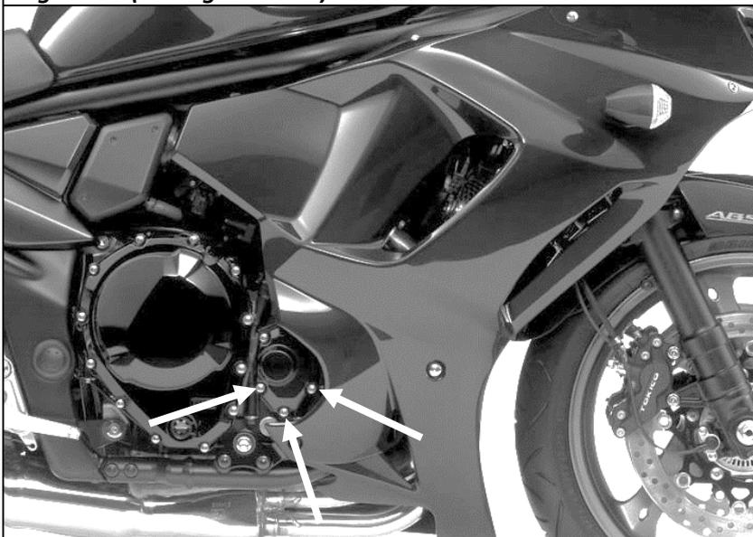
Das Sturzpad wird an dem Motordeckel (unten, vorne) montiert.
