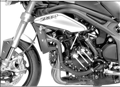
Das Sturzpad wird an der vorderen Verbindung von Motor und Rahmen (unter der Verkleidung) sowie dem Motordeckel montiert.
