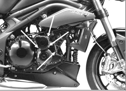
Das Sturzpad wird am Motordeckel (vorne, in Fahrtrichtung) montiert.
