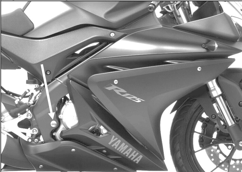
Die Mutter M16x1,5 ist mit 30Nm anzuziehen. Im Anschluss bitte die vormontierte Grundplatte anbringen.
