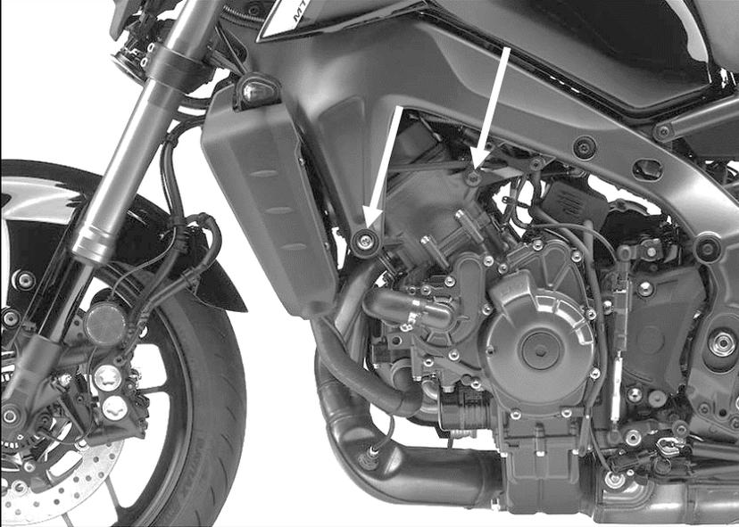
Das Sturzpad wird an der seitlichen Verbindung von Motor und Rahmen sowie am Rahmen montiert. Dem äußersten Punkt des Motordeckels kann wegen der ausladenden Geometrie kein Schutz gewährleistet werden.
