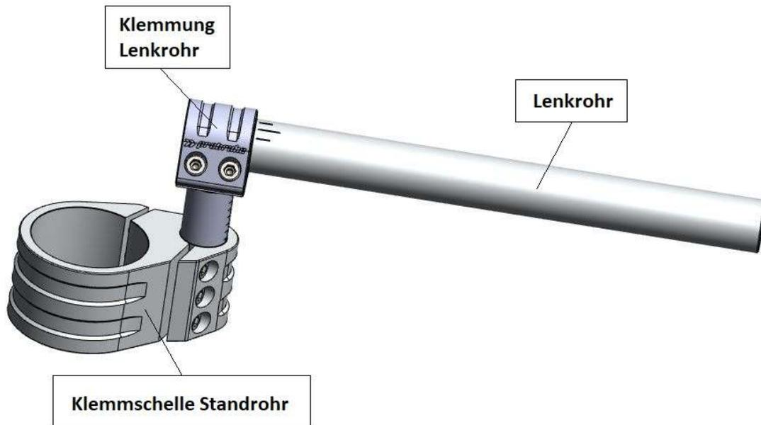
**„Lenkerrohr“ und „Klemmung Lenkerrohr“ müssen zur sachgemäßen Befestigung über die gesamte Länge in die Klemmbohrungen eingeschoben werden!** Abweichende Kennzeichnungen sind nichtig.
